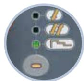
**3T SPECIAL:** permet de configurer et de rappeler en mode automatique, à l'aide du bouton de la torche, trois niveaux différents de courant pour des cordons de haute qualité; conseillé pour le soudage de l'aluminium.
