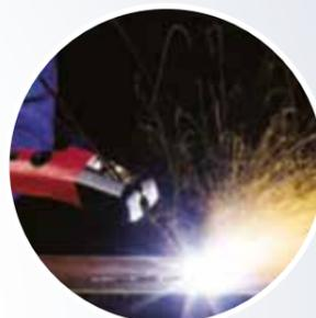
La fonction ARC AIR permet de gouger avec des électrodes au carbone jusqu'à 6mm de diamètre (Cruiser 402) et 8mm (Cruiser 502). Il est possible d'utiliser deux générateurs en parallèle pour obtenir 1000 A pour le gougeage.
