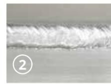
**NIVEAU 2:** On utilise le courant de soudage optimisé pour l'épaisseur et l'usinage exigés.
