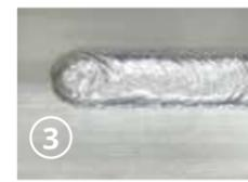
**NIVEL 3:** una corriente reducida termina la soldadura de forma óptima, llenando el cráter final en el cordón.
