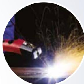
La función Arc Air permite ranurar perfectamente con electrodos de carbón de hasta 6mm de diámetro (Cruiser 402) y 8mm (Cruiser 502). Se pueden acoplar dos generadores para obtener 1000A para ARCO AIRE.
