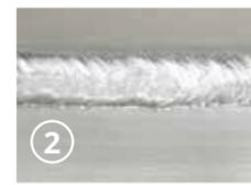
**NIVEL 2:** se usa la corriente de soldadura optimizada para el grosor y la elaboración solicitada.
