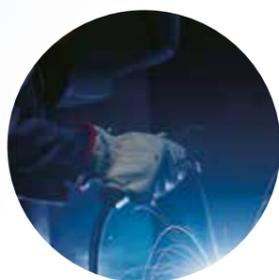
Cruiser 322 - 402 - 502 AC/DC consente di saldare elettrodi rivestiti di tipo: BASICO - RUTILICO - CrNi - Alluminio.
