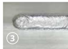
**LIVELLO 3:** una corrente ridotta termina la saldatura in modo ottimale riempiendo il cratere finale sul cordone.
