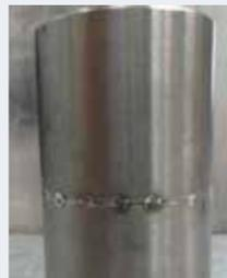
Puntatura (ad angolo) spessore 0,6 mm.
