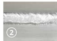
**LIVELLO 2:** si usa la corrente di saldatura ottimizzata per lo spessore e la lavorazione richiesta.
