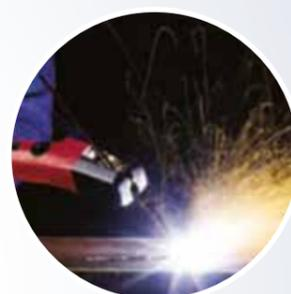
La funzione ARC AIR consente di scriccare perfettamente con elettrodi di carbone fino a 6mm di diametro (Cruiser 402 AC/DC) e 8mm (Cruiser 502 AC/DC). La possibilità di parallellare 2 generatori consente di scriccare con una corrente fino a 1000Ampere.
