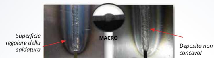
Superficie regolare della saldatura
