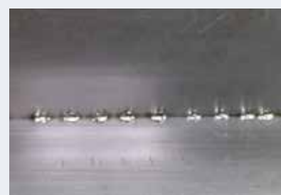
Punteado (de ángulo) grosor 0,6 mm.
