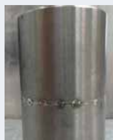
Tubo (cabeza cabeza) Ø 31,75 x 2 mm.
