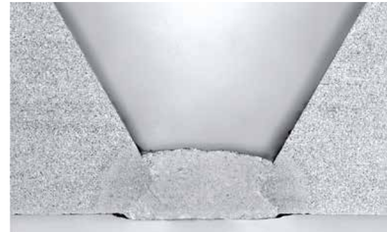
Radiographie du Joint de Soudage
