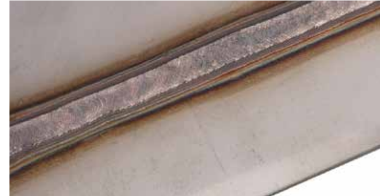
Transferencia muy lineal con una bañabilidad de los cantos óptima y una velocidad de ejecución muy elevada
