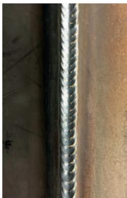
Saldatura in PF spigolo esterno
