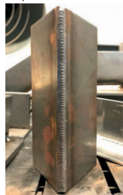
Soldadura en PF de esquina exterior
