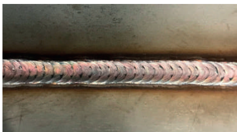
Soldadura en PB
