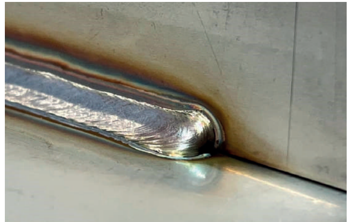
Cordón de soldadura con cebado por arco DSI
