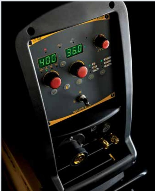
I carrelli trainafile WF103 e WF105 hanno di serie la presa fissa per saldare in modalità MMA e Scriccatura
