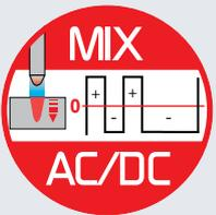
La función **MIX AC/DC** permite modular la corriente de soldadura alternando un semiperiodo en TIG de AC con un semiperiodo en TIG de DC-. Esto permite combinar la eficacia de la soldadura TIG de AC en la penetración de la soldadura TIG de DC-, obteniendo alta velocidad de soldadura y creando más rápidamente el baño de soldadura con la pieza fría.
