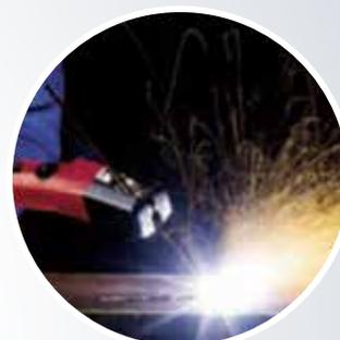
La función Arc Air permite ranurar perfectamente con electrodos de carbón de hasta 6mm de diámetro (Cruiser 402 AC/DC) y 8mm (Cruiser 502 AC/DC). Se pueden acoplar dos generadores para obtener 1000A para ARCO AIRE.
