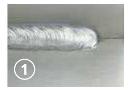
**STUFE 1:** Der richtige Anfangsstrom garantiert die optimale Einbrandtiefe schon beim Zünden.
