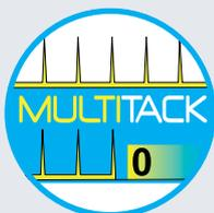
Die **MULTITACK** Funktion ist eine Sonderfunktion, speziell für das Verschweißen von dünnen Blechen. Das Gerät gibt kurzzeitige Schweißintervalle ab, dadurch kann das Material in den Pausenphasen ganz abkühlen. Durch Einsatz dieser Funktion kann sowohl die Bildung von Anlauf-farben, als auch der Verzug erheblich reduziert werden.
