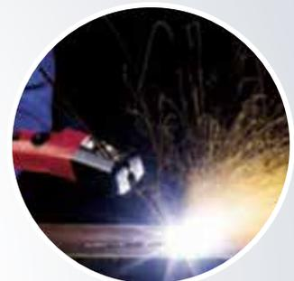
Bei dieser Funktion kann bis zu 6 mm dicken Fugen-Elektroden ausgefugt werden (402AC/DC) oder bis zu 8 mm Fugen-Elektroden (502 AC/DC).
