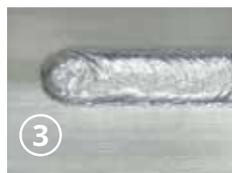
**STUFE 3:** Am Ende des Schweißvorgangs kann man den Strom zum optimalen Füllen des Kraters absenken.
