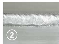
**STUFE 2:** Man verwendet auszuführende Bearbeitung optimierten Schweißstrom.
