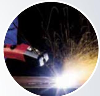
Bei dieser Funktion kann bis zu 6 mm dicken Fugen-Elektroden ausgefügt werden (402T) oder bis zu 8 mm Fugen-Elektroden (502T).
