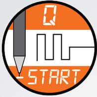
Die **Q-START** (Quick-Start) Funktion vereinfacht den Schweißstart. Mit dieser Funktion schaltet die Maschine für einen einstellbaren Zeitraum auf den Synergic Puls um. Die Synergic Puls Funktion versetzt das Schmelzbad in gezielte Schwingungen, und hilft somit die Schmelzlinse schneller zu schließen. Dadurch kann sehr schnell mit dem eigentlichen Schweißvorgang begonnen werden. Unnötiger Wärmestau zu Beginn des Schweißens wird vermieden.
