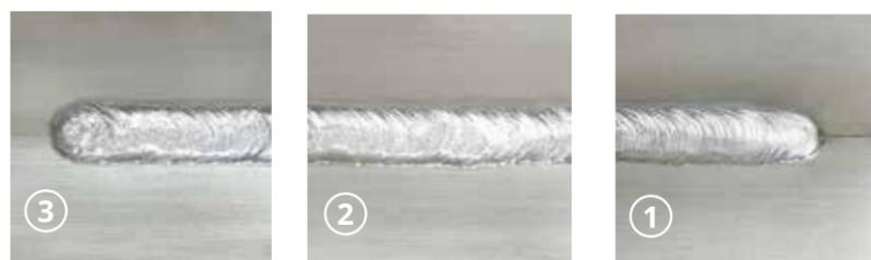
**NIVEAU 3:** Un courant réduit termine le soudage d'une manière optimale, remplissant le cratère final sur le cordon.
