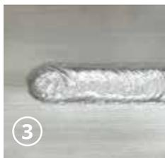
**NIVEL 3:** una corriente reducida termina la soldadura de forma óptima, llenando el cráter final en el cordón.
