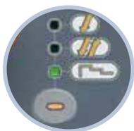
**3T SPECIAL:** permite configurar y seleccionar de forma automática con el botón de la antorcha 3 niveles de corriente para cordones de alta calidad: aconsejado para soldadura de aluminio.
