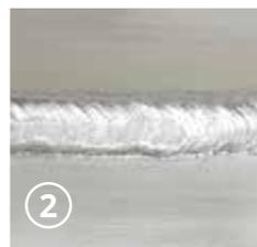
**NIVEL 2:** se usa la corriente de soldadura optimizada para el grosor y la elaboración solicitada.
