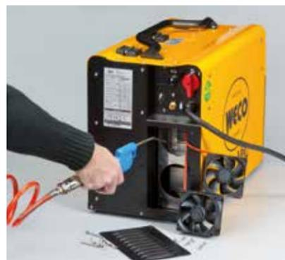
Griglie di ventilazione anteriore, posteriore e ventilatori rimovibili, consentono una facile pulizia dei dissipatori di calore, attraverso il soffiaggio con aria compressa.
