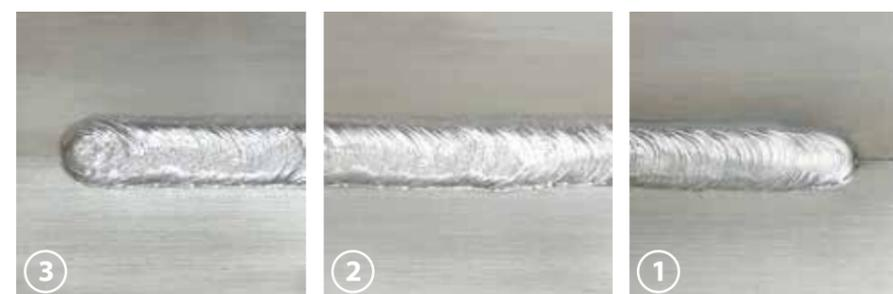
**LIVELLO 3:** una corrente ridotta termina la saldatura in modo ottimale riempiendo il cratere finale sul cordone.
