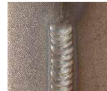
**SALDATURA IN POSIZIONE:** HAC fornisce un arco short con ottima fusione ai margini del cordone che facilita le saldature in posizione sovra-testa e verticale ascendente.
