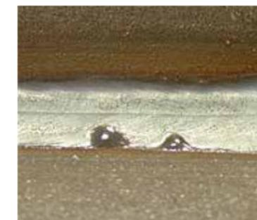
**SPRAY ARC:** HAC permite un arco spray corto con mejor penetración en el vértice, menor aporte calórico, más velocidad de soldadura y ausencia de incisiones marginales y proyecciones.
