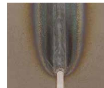
**POSICIÓN PG:** HAC permite soldar planchas finas en vertical descendente con separación hasta 5 mm entre los cantos.
