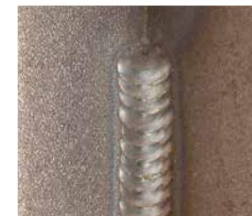
**SOLDADURA EN POSICIÓN:** HAC proporciona un arco short con óptima fusión en los márgenes del cordón, que facilita la soldadura en posición sobre la cabeza y vertical ascendente.
