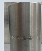
Tubo (testa testa) Ø 31,75 x 2 mm.
