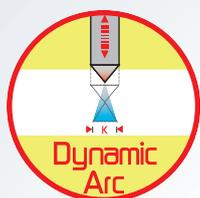
Questa funzione consente di mantenere costante il prodotto Tensione x Corrente. Il generatore aumenta la corrente di saldatura al diminuire della tensione d'arco e diminuisce il valore di corrente di saldatura se la tensione d'arco aumenta. Il valore di DynARC si può regolare da un minimo di 1Ampere ad un massimo di 50Ampere ad ogni variazione di 1Volt sia essa positiva o negativa.
