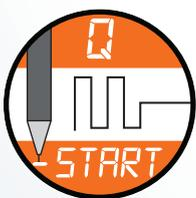
La funzionalità Q START (Quick start) agevola l'unione delle parti da saldare in fase iniziale della saldatura. Una serie di impulsi di durata regolabile crea un movimento del materiale fuso dei due lembi accelerandone l'unione. Molto utile nel caso di lembi con leggere aperture o con preparazione non regolare.
