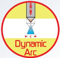
La fonction DYNAMIC ARC permet de garder constant le produit tension x intensité. Le générateur augmente l'intensité de soudage à mesure que la tension d'arc diminue et réduit la valeur du courant de soudage lorsque la tension d'arc augmente. La valeur DYNAMIC ARC peut se régler à un minimum de 1 ampères jusqu'à un maximum de 50 ampères à chaque variation de 1Volt soit positive que négative.
