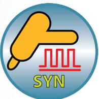
Pulsé SYN (Synergique) permet d'avoir toujours une impulsion équilibrée en réglant uniquement le courant de soudure. Le générateur règle automatiquement d'une manière synergique les valeurs de courant de base, le temps de crête et la fréquence d'impulsions en fonction du courant de soudage réglé. Utile pour les applications sur des plaques légèrement oxydées. Évite l'ébullition du bain et réduit la contamination de l'électrode.
