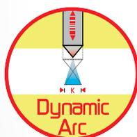
Il Dynamic Arc è una funzione che permette, alla riduzione della tensione dell'arco, un aumento della corrente di saldatura e viceversa. Questo permette il controllo dell'apporto termico al pezzo e della penetrazione con il solo movimento della torcia.
