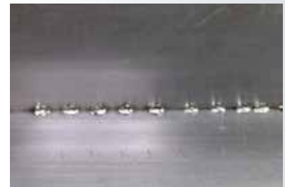
Puntatura (ad angolo) spessore 0,6 mm.
