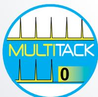
El sistema **MULTITACK** permite reducir al mínimo el aporte térmico durante la unión de dos piezas de grosor fino. La serie de cebados a breves lapsos de tiempo permite, durante la pausa entre un cebado y otro, enfriar el material y, por lo tanto, limitar al mínimo su deformación. La posibilidad de regular la frecuencia de la serie de cebados en la unidad de tiempo permite adaptar el arco eléctrico a la velocidad de soldadura y a la geometría de la junta.
