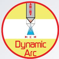
La función **DYNAMIC ARC** permite mantener constante el producto Tensión x Corriente. El generador aumenta la corriente de soldadura al disminuir la tensión del arco y disminuye el valor de corriente de soldadura si aumenta la tensión del arco. El valor de DynARC se puede regular con un mínimo de 1 amperio hasta un máximo de 50 amperios en cada variación de 1 voltio, ya sea positiva o negativa.
