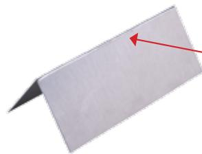
Soldadura de la arista de una pieza con grosor de 0,8 mm
