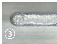
**STUFE 3:** Am Ende des Schweißvorgangs kann man den Strom zum optimalen Füllen des Kraters absenken.
