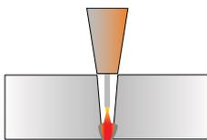
Besonders beim Schweißen von tiefen V-Nähten und Vollanschlüssen (HV - Kehlnaht) bietet dieses Verfahren eine erhöhte Prozesssicherheit. Der Hohe Lichtbogen druck ermöglicht sicheres Durchdringen der Wurzel und bietet signifikant verbesserte Modellierbarkeit beim mehrlagigen Schweißen. Weiter wird die Silikatbildung deutlich reduziert.
