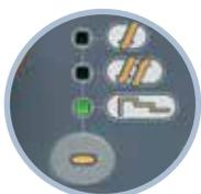
**3T SPECIAL:** Mit dieser Funktion kann man über den Brenntaster 3 verschiedene Stromstärken einstellen und abrufen, um qualitativ hochwertige Nähte zu erzeugen: Sie empfiehlt sich zum Schweißen von Aluminium.
