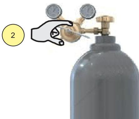
2. Regolare la pressione del gas uscente dalla torcia tramite il flussimetro collegato alla bombola del gas.
