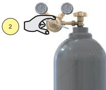
2. Regule la presión del gas que sale de la antorcha mediante el caudalímetro conectado a la botella del gas.
