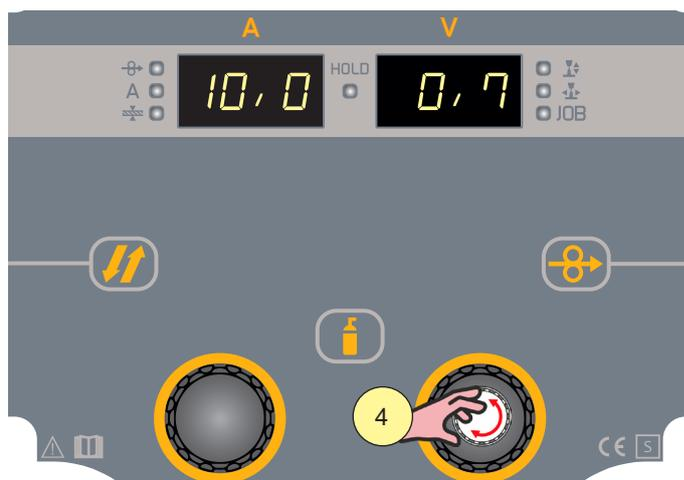
3. Drücken Sie die Encodertaste, um die Bearbeitung des Parameters zu aktivieren.
