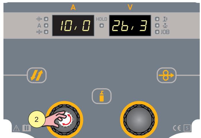
1. Drücken Sie die Encodertaste, um die Bearbeitung des Parameters zu aktivieren.
