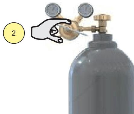
2. Die Gasdurchflussmenge wird am Druckminderer eingestellt.
