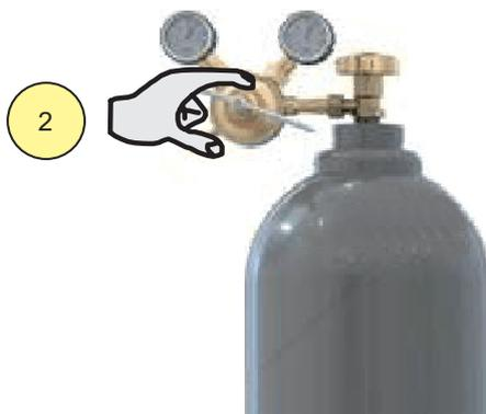
9. Den Druck des aus dem Brenner kommenden Gases mit dem an die Gasflasche angeschlossenen Durchflussmesser regulieren.
