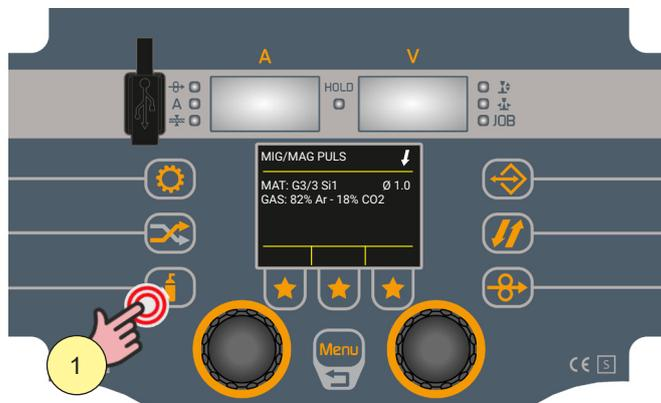
8. Öffnen Sie das Gas-Magnetventil durch Drücken und Loslassen der Taste
