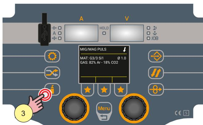
10. Schließen Sie das Gas-Magnetventil durch Drücken und Loslassen der Taste
