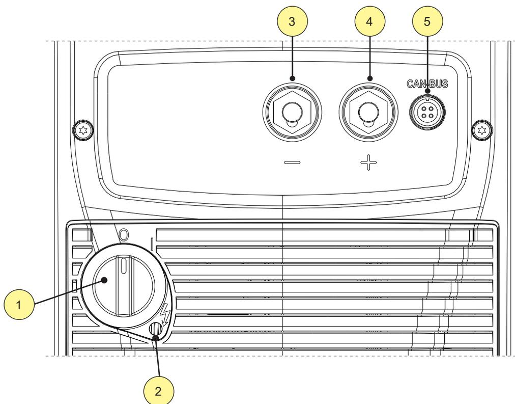
1. Interrupteur d'arrêt et d'allumage du générateur.
