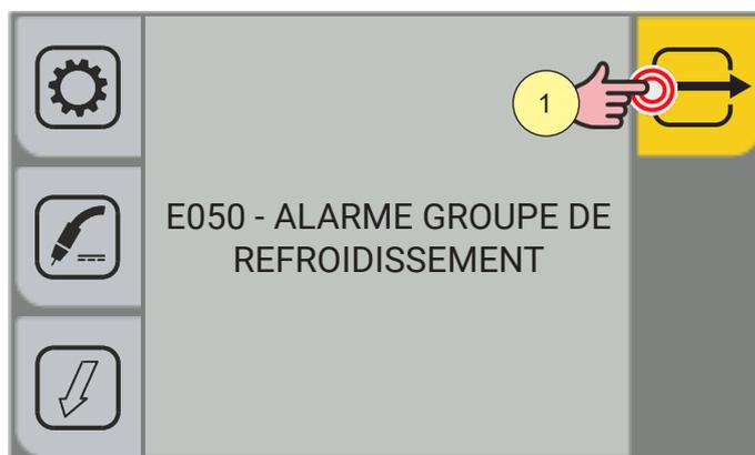
1. Appuyer sur la touche [SORTIE] pour répéter la procédure de remplissage de la torche, jusqu'à ce que l'alarme ne s'affiche plus.
