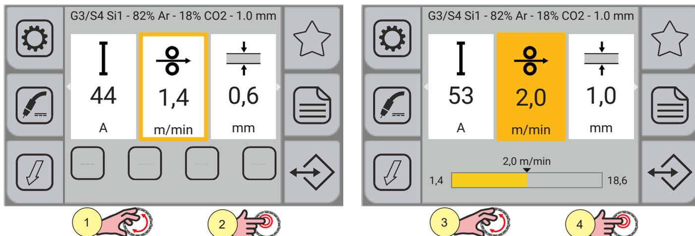
1. Tourner l'encodeur pour sélectionner le paramètre à modifier ; la sélection est signalée par le bord plus épais autour de l'encadré.
