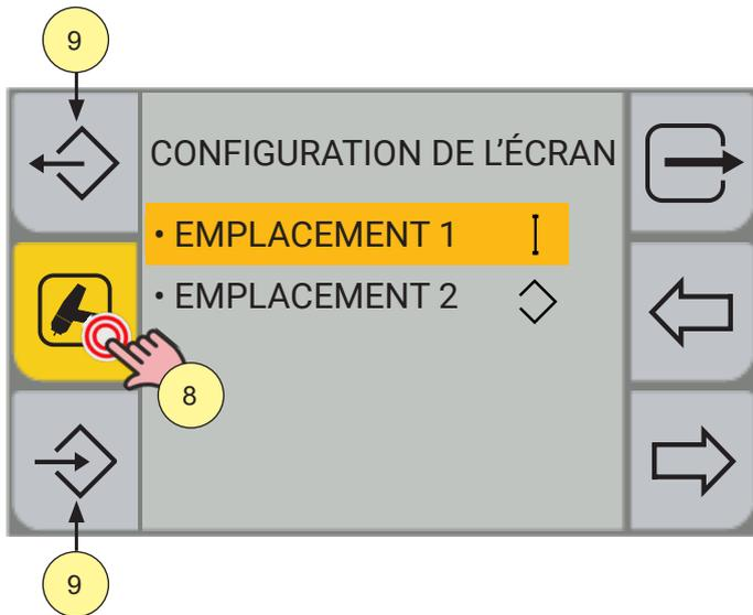
8. La page de configuration de l'écran est liée au processus de soudage. En appuyant à plusieurs reprises sur la touche de sélection du processus, il est possible de faire défiler les différentes pages de configuration de l'écran des différents processus de soudage.
