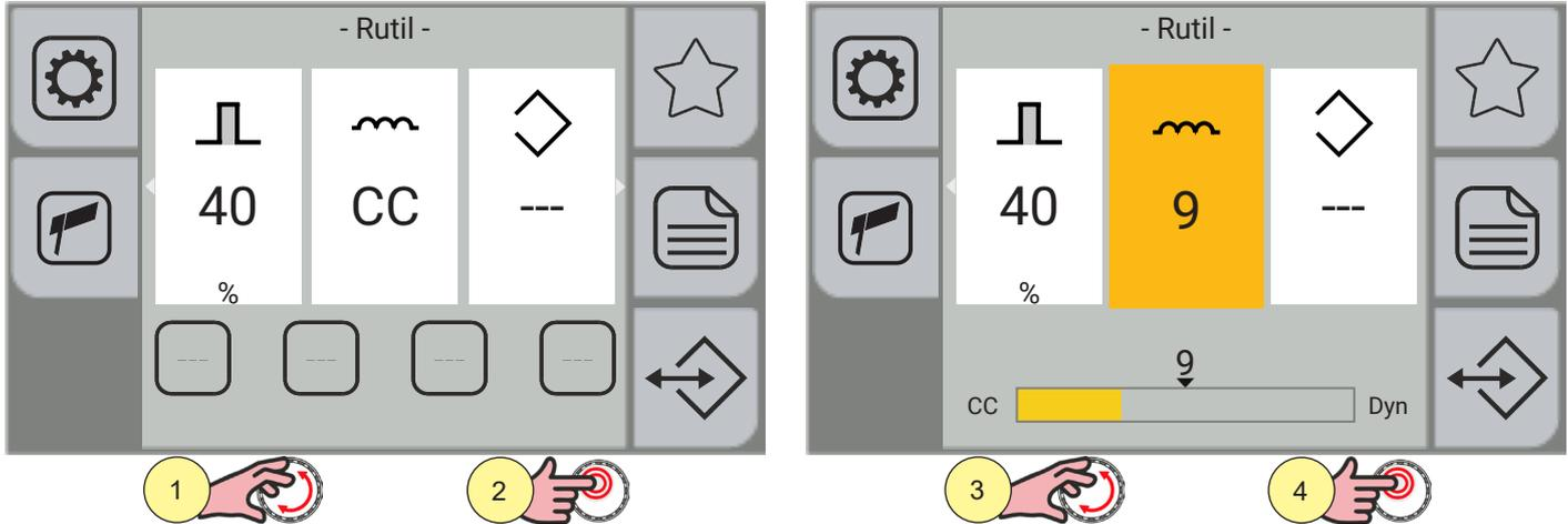
1. Tournez l'encodeur pour sélectionner le paramètre à modifier.
