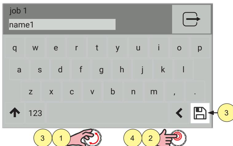
1. Tourner l'encodeur pour sélectionner la lettre sur le clavier.
