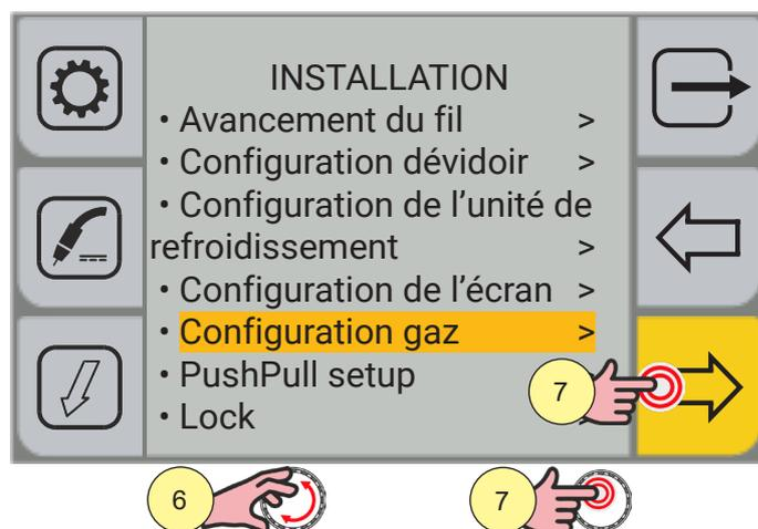
4. Tourner l'encodeur pour sélectionner le réglage souhaité.
