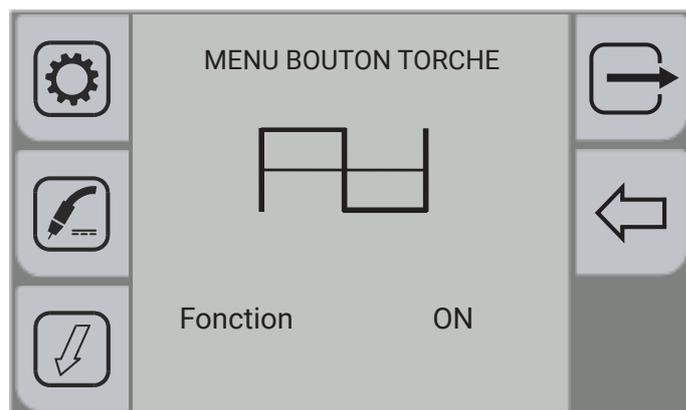
4. Tournez l'encodeur pour sélectionner l'élément souhaité. Sélectionner le chemin suivant : Spot/pause>
