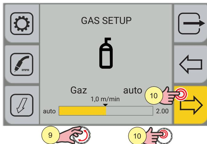
8. Appuyer sur la touche [ENCODEUR] pour activer la modification du paramètre.
