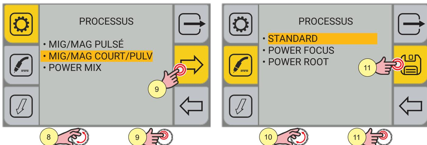
PROCESSUS (1 NIVEAU) : permet de sélectionner uniquement les processus de soudage compatibles avec les paramètres précédemment définis.
