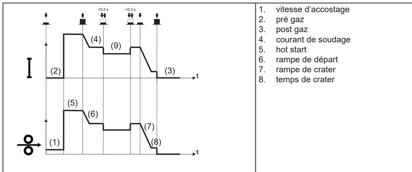
Le processus de soudage est le même que le 4T - 3 NIVEAUX, à la différence que durant la vitesse normale de soudage, si on appuie et relâche immédiatement le bouton de la torche, on passe au second courant de soudage.
