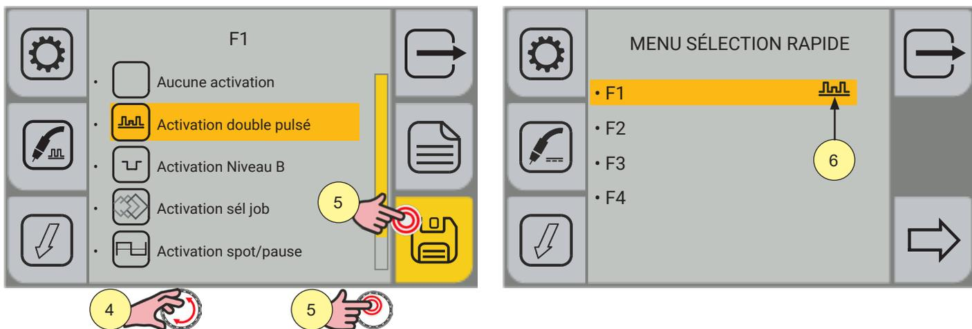
4. Tourner l'encodeur pour sélectionner la fonction souhaitée.
