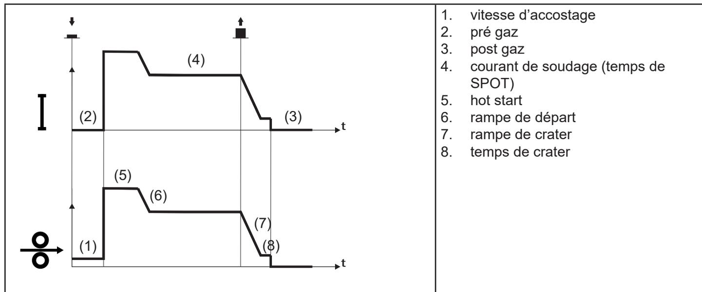
Le processus de soudage est le même que le 2T - 3 NIVEAUX, à la différence que l'on reste en soudage, à l'intensité réglée, pendant le temps configuré avec le paramètre temps de spot.
