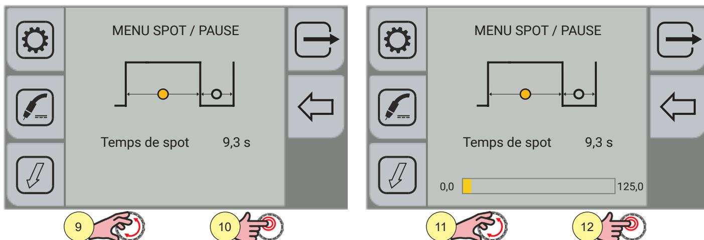
9. Tourner l'encodeur pour sélectionner le paramètre souhaité.
