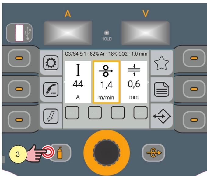
3. Fermer l'électrovanne du gaz en appuyant et en relâchant la touche [GAZ]. L'électrovanne se ferme automatiquement après 30 secondes.
