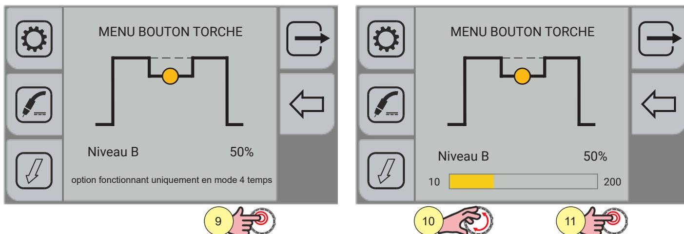
9. Appuyer sur la touche [ENCODEUR] pour activer la modification du paramètre.
