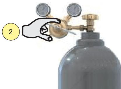
2. Die Gasdurchflussmenge wird am Druckminderer eingestellt.
