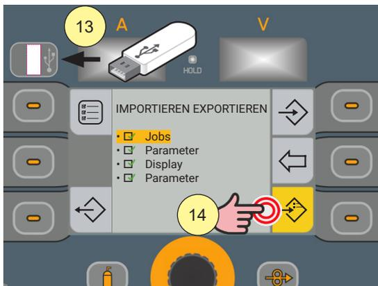
1. Stecken Sie einen USB-Stick in den entsprechenden Anschluss ein.
