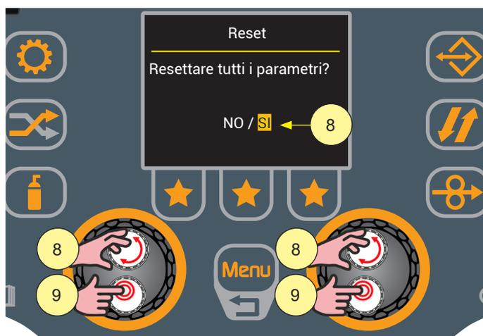
8. Ruotare l'encoder per selezionare "SI".
