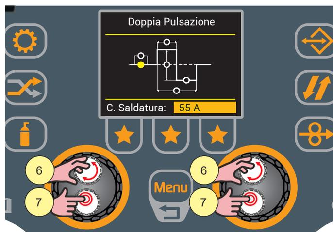
4. Ruotare l'ecoder per selezionare il parametro da modificare.
