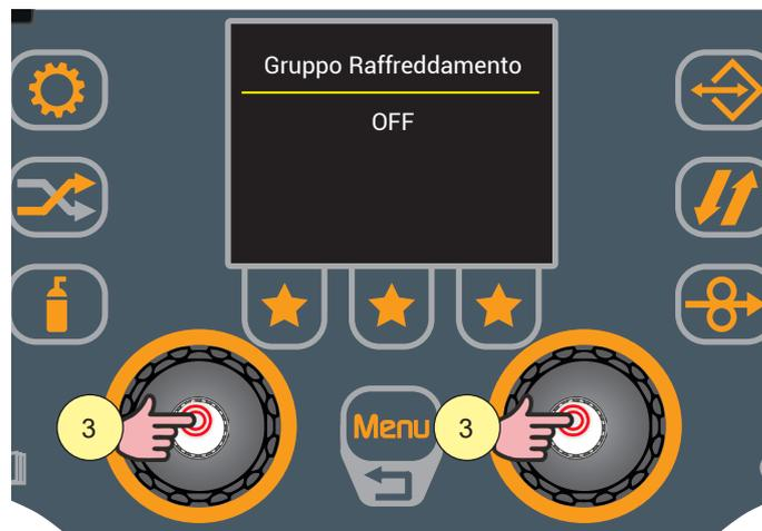
1. Selezionare l'impostazione desiderata ruotando l'encoder. Selezionare il seguente percorso: Configurazione CU>
