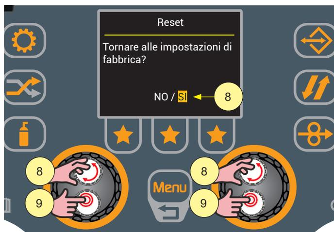
8. Ruotare l'encoder per selezionare "SI".
