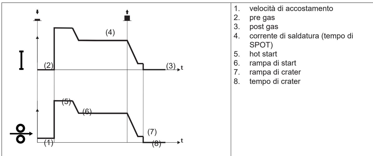
Il processo di saldatura è lo stesso del 2T - 3 LIVELLI, solo che si rimane in saldatura, alla corrente impostata, per il tempo impostato con il parametro tempo di spot. La chiusura della saldatura avviene come il 2T - 3 LIVELLI.
