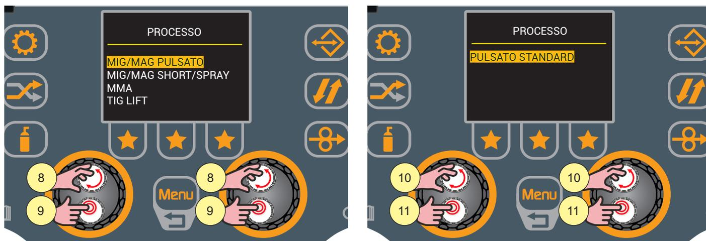
► **PROCESSO (1 livello):** permette di selezionare solo i processi di saldatura compatibili con le impostazioni precedentemente fatte.
