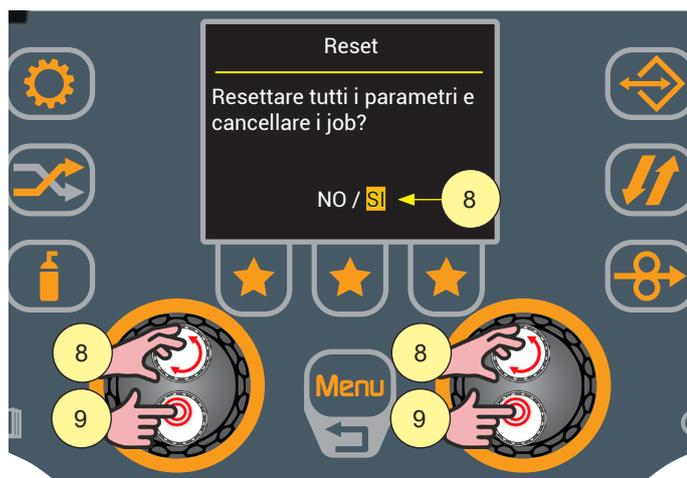
8. Ruotare l'encoder per selezionare "SI".
