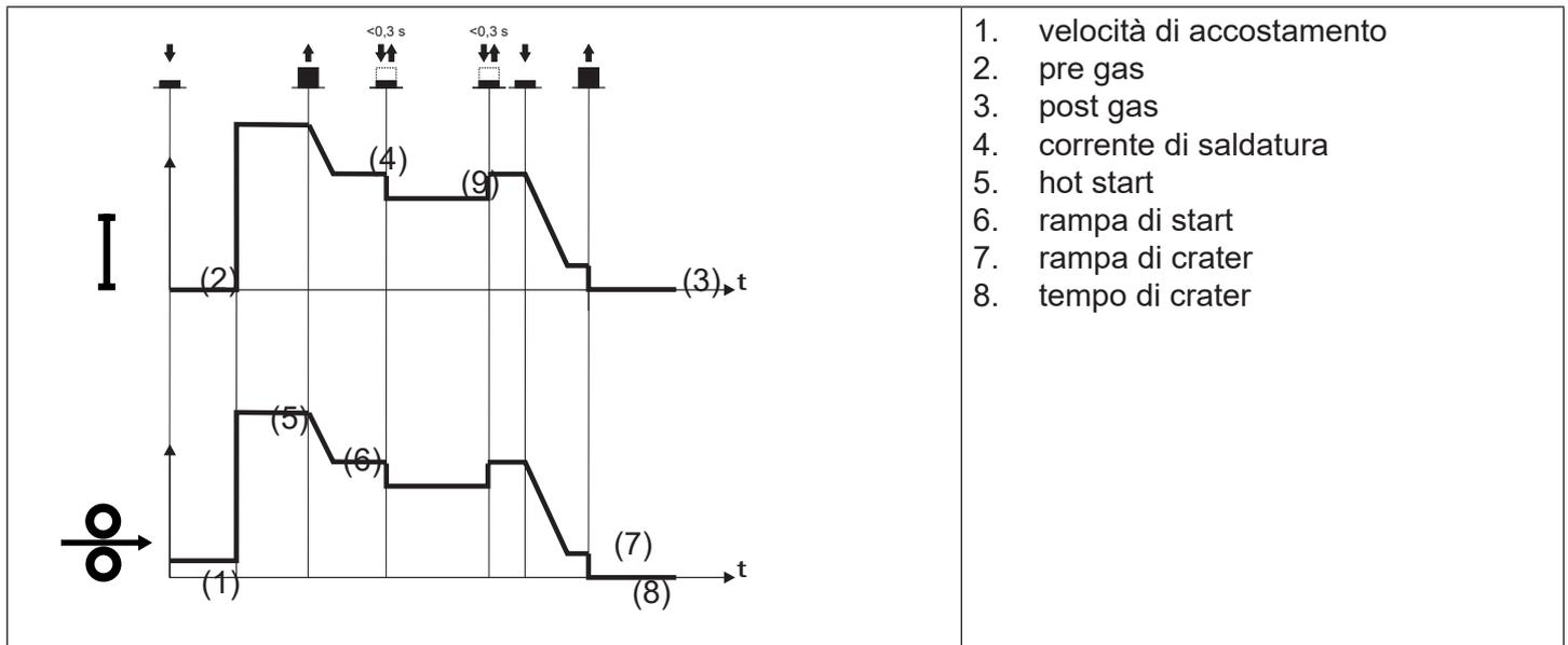
Il processo di saldatura è lo stesso del 4T - 3 LIVELLI, solo che durante la velocità normale di saldatura, se si preme e rilascia subito il pulsante della torcia si passa alla seconda corrente di saldatura.
