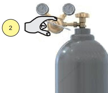
9. Regolare la pressione del gas uscente dalla torcia tramite il flussimetro collegato alla bombola del gas.
