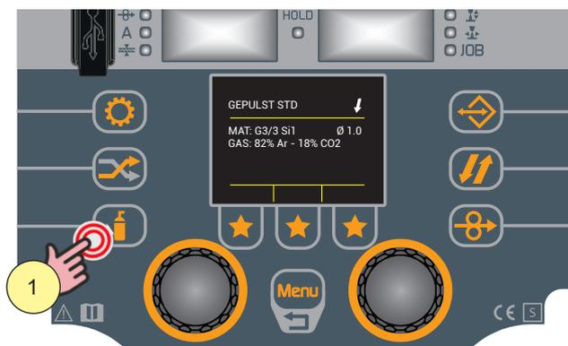
10. Schließen Sie das Gas-Magnetventil durch Drücken und Loslassen der Taste
