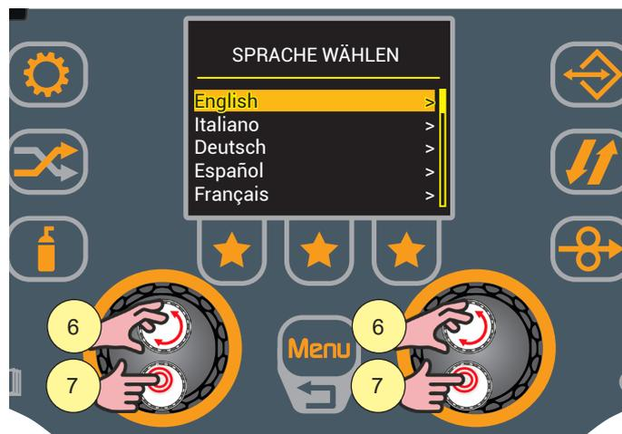
4. Wählen Sie die gewünschte Einstellung durch Drehen des Drehschalters.
