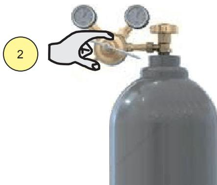
9. Regule la presión del gas que sale de la antorcha mediante el caudalímetro conectado a la botella del gas.
