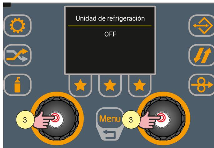
1. Seleccione el ajuste deseado girando el codificador.
