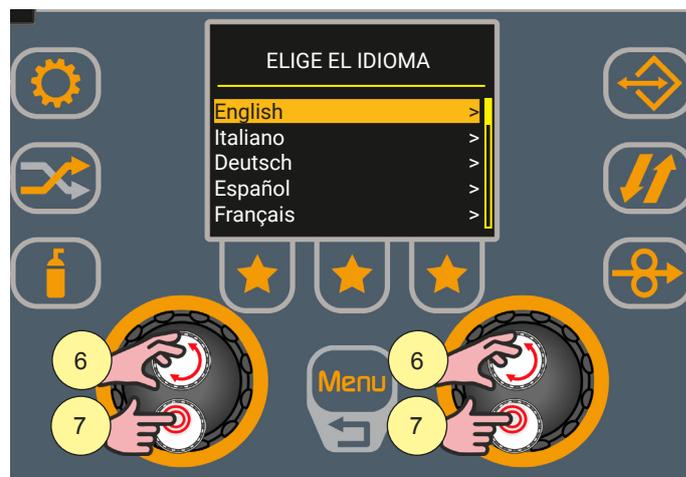
4. Seleccione el ajuste deseado girando el codificador.
