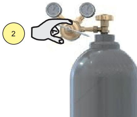
9. Die Gasdurchflussmenge wird am Druckminderer eingestellt.
