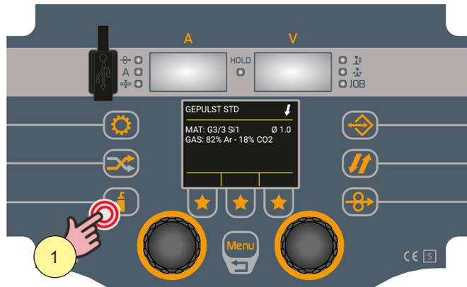
8. Öffnen Sie das Gas-Magnetventil durch Drücken und Loslassen der Taste
