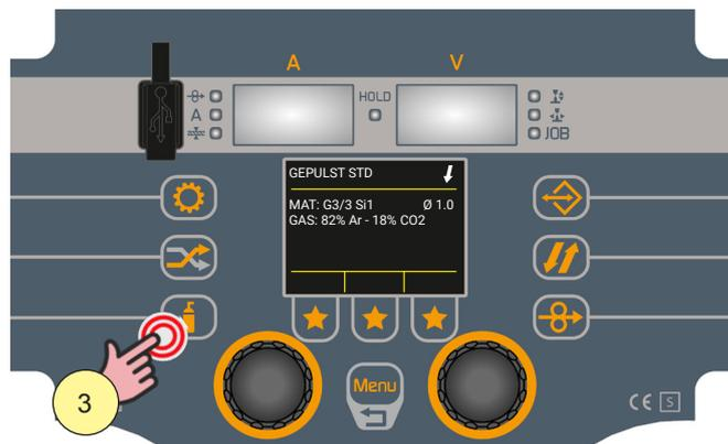
10. Schließen Sie das Gas-Magnetventil durch Drücken und Loslassen der Taste
