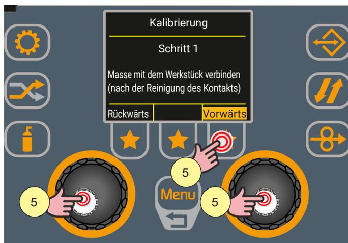
4. Drücken Sie zur Bestätigung die Encodertaste oder die [Weiter]-Taste oder die Brenntaste.
