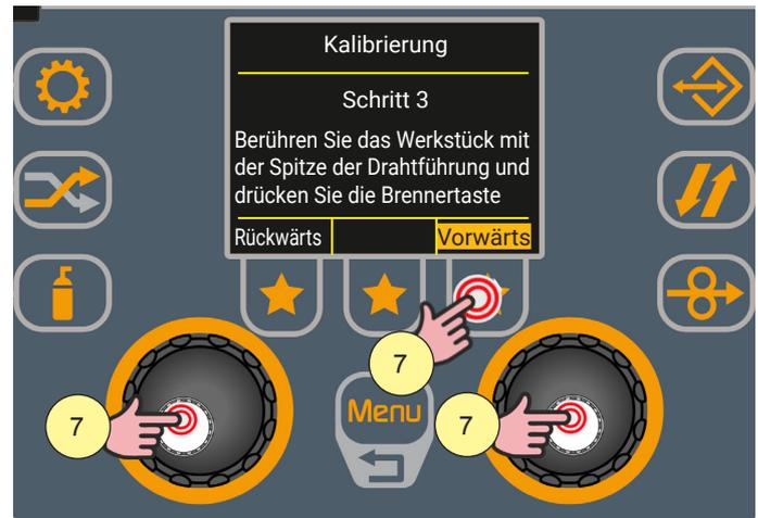
6. Folgen Sie den Anweisungen auf dem Display (Schritt 2) und drücken Sie dann die Encodertaste oder die [Weiter]-Taste oder die Brenntaste, um zu bestätigen.
