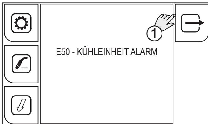
1. Die Taste (BEENDEN) drücken, um das Verfahren zum Füllen des Brenners zu wiederholen, bis der Alarm nicht mehr angezeigt wird.
