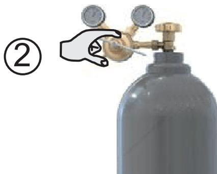
2. Die Gasdurchflussmenge wird am Druckminderer eingestellt.
