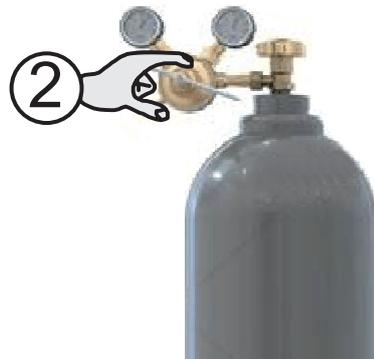
2. Die Gasdurchflussmenge wird am Druckminderer eingestellt.
