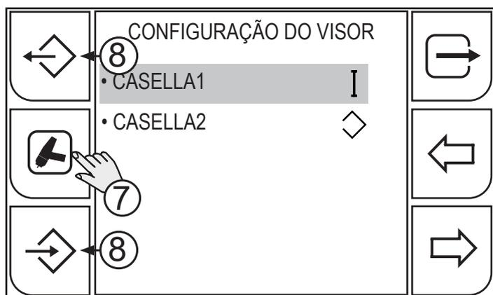
7. O ecrã de configuração do visor está associado ao processo de soldagem. Pressionar a tecla de seleção de processo percorre repetidamente as diferentes ecrãs de configuração de exibição dos vários processos de soldagem.
