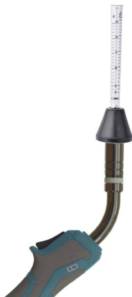
Para medir correctamente el volumen de gas a la salida de la antorcha se aconseja el uso de un medidor de flujo de gas, a colocar directamente a la salida de la antorcha.
