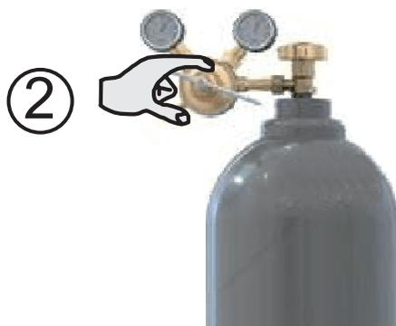
2. Regule la presión del gas que sale de la antorcha mediante el caudalímetro conectado a la botella del gas.
