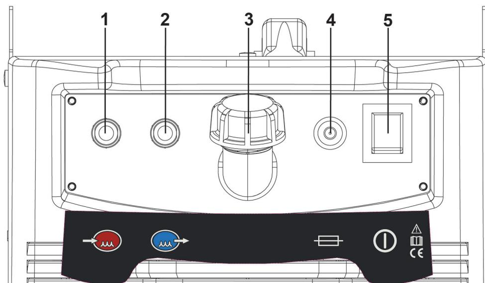
Raccordement (entrée) pour le tuyau du liquide de refroidissement : flux du liquide du générateur/torche vers l'unité de refroidissement [Part. 1].
