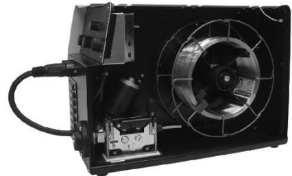
22. Die Bremse der Spulenträgerspindel durch Anziehen bzw. Lösen der Schraube so einstellen, dass beim Abspulen der Draht nicht zu stark unter Zug steht und die Spule beim Anhalten sofort stoppt, ohne zu viel Draht abzuwickeln.
