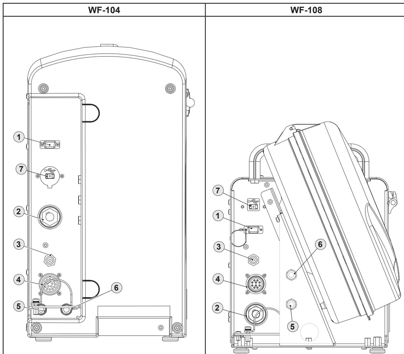
1: Connettore per il collegamento al programmatore.
