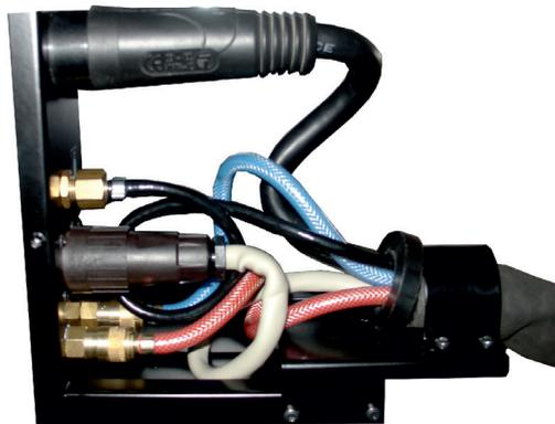
10. Collegare la spina della pinza massa alla presa di massa del generatore di corrente.
